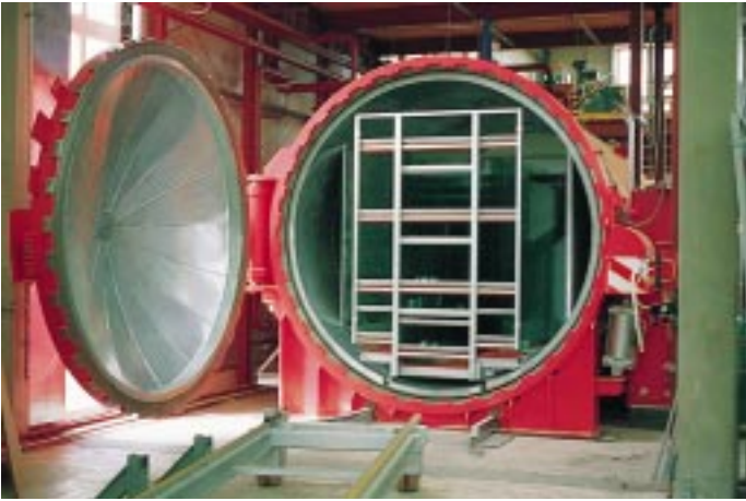
Neue VSG-Anlage: Blick in den geöffneten Autoklav Bild: Kaufmann-Laminex
