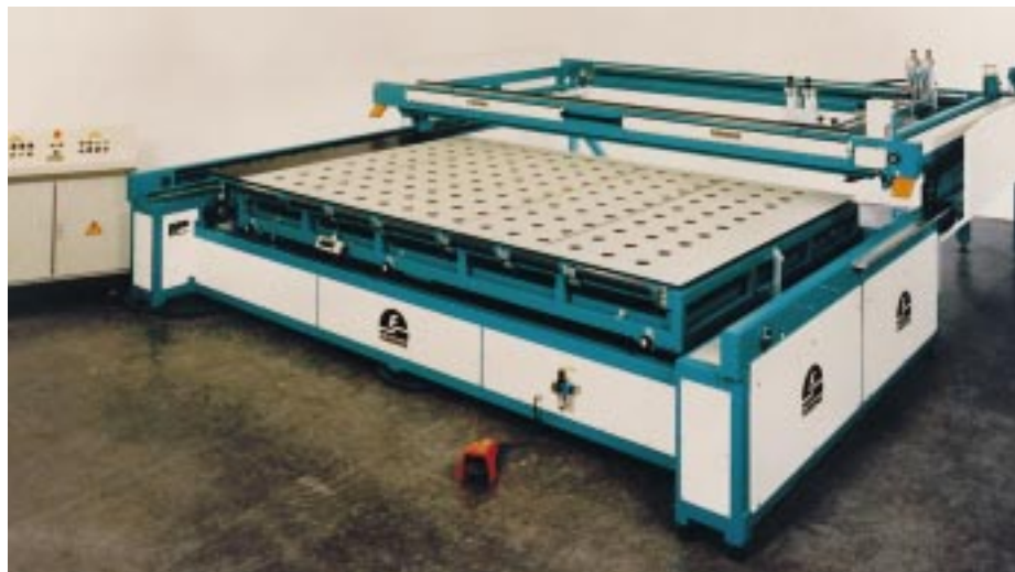
Siebdruckmaschine „SH“ mit höhenverstellbarer Anschlagplatte, Nuten und Kugelrollentisch
