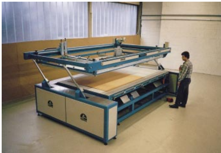
Siebdruckmaschine „LP“ für Druckformate von max. 2200 x 4500 mm
