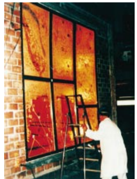
„Pyranova“ im Brandversuch
