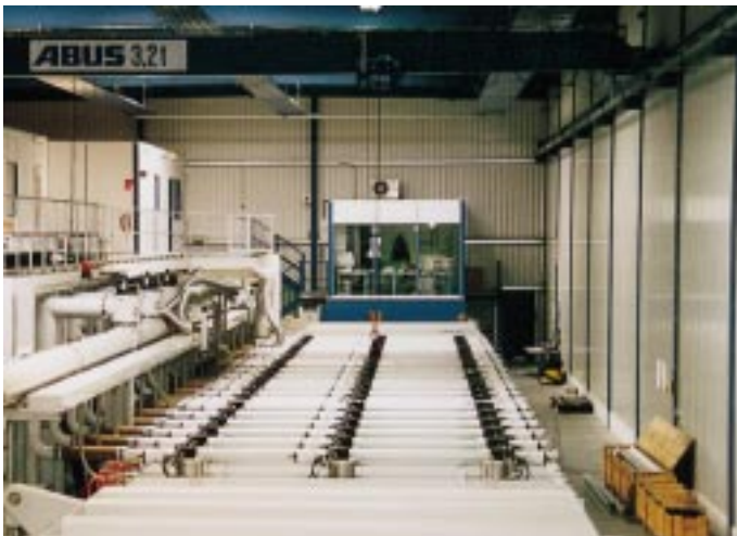
Neue Technologie für hohen Qualitätsstandard: die Vakuum-Beschichtungsanlage von Leybold
