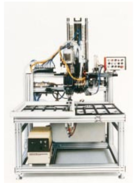
Interessante Rationalisierungspotentiale erschließt dieser Montageautomat für Blendrahmenbeschläge Bild: Böllhoff
