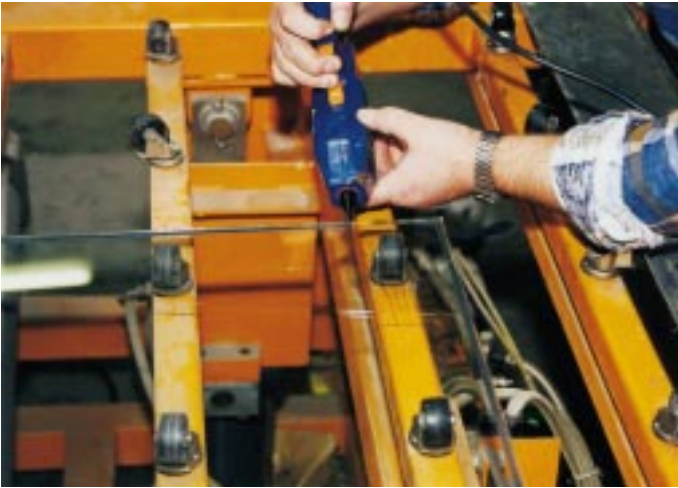
Nach der exakten Berechnung durch den Computer wird die notwendige Gießharzmenge millilitergenau dosiert
