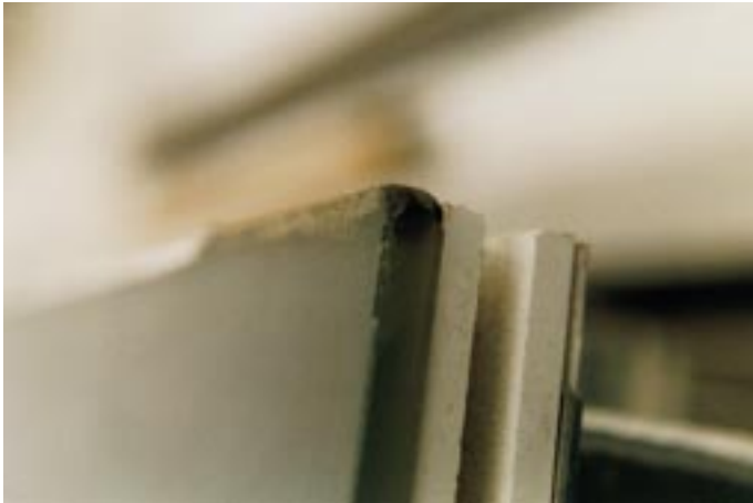
Glaskantenbeschädigungen, die größer als 15 % in die Glasmasse eingreifen – ein Einbau ist nicht mehr zulässig, wenn solche Beschädigungen nach dem Vorspannprozeß vorkommen
