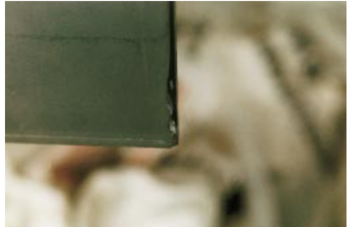
Glaskantenbeschädigungen, die größer als 15 % in die Glasmasse eingreifen – ein Einbau ist nicht mehr zulässig, wenn solche Beschädigungen nach dem Vorspannprozeß vorkommen
