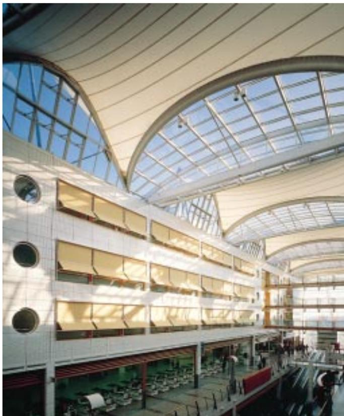
Als außenliegendes System schirmen Außenraffstores die Strahlungswärme besonders effektiv ab, die wendbaren Lamellen lassen sich den herrschenden Lichtverhältnissen jederzeit optimal anpassen und ermöglichen zudem den Bezug nach außen. Eine SPS-
