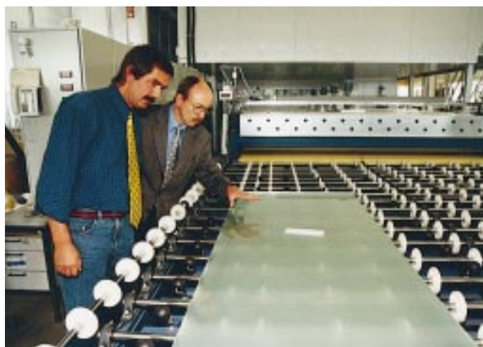
Mit einer neuen horizontalen Fertigungsanlage für ebenes VSG der Armatec Vierhaus GmbH, Gunzenhausen, baut Interpane Sicherheitsglas Hildesheim vorhandene Kapazitäten aus, setzt die schrittweise Modernisierung der Produktion fort und investiert in die Zukunft des Unternehmens. Die neue Fertigungsanlage kann VSG von Maßen 2600 x 3650 m im Automatikbetrieb herstellen. Im manuellen Betrieb sind in Zukunft sogar Produktionsgrößen von 2600 x 6000 m möglich. Mit dieser Investition erhöht sich die Kapazität bei der VSG-Produktion um rund 30 Prozent. Bild: Interpane
