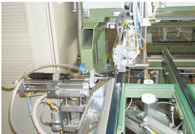
trennt voneinander gesteuert und automatisch getaktet werden. Das Anschlagsystem ist profilneutral und ermöglicht eine hohe Flexibilität bei der Fensterherstellung. Der Flügeltransport erfolgt über den Flachriemen besonders schonend. Zusammen mit dem
