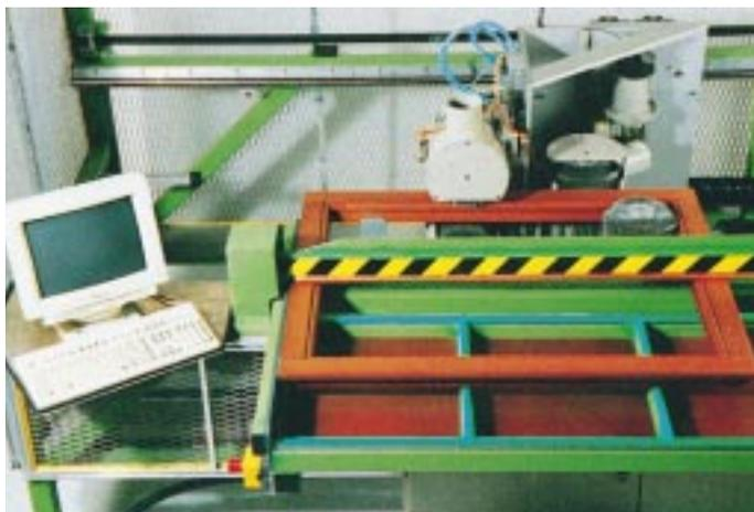
zen. Einsetzbar sind Bürsten mit Silicium-Korbitbesatz sowie Bürsten mit Schleifgewebe und Stützbürsten. Zwei unabhängige Bearbeitungsachsen führen die einzelnen, frei programmierbaren Arbeitsabläufe aus. Die einzelnen Arbeitsschritte können am Bildschirm genau verfolgt werden. Ein weiterer Vorteil ist, daß das Schleifmedium dem Fensterprofil angepaßt ist, so daß die Fälze, Schlagleisten und Rolladenleisten weitgehendst formschlüssig geschliffen werden.
