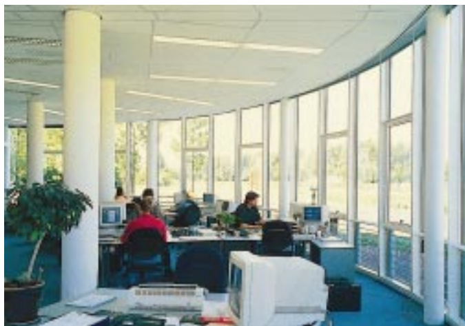
Zustand des elektrochromen Glases: hell – Lichttransmission T_L = 50\%
