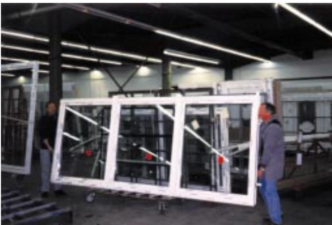
Nicht selten sind Fensterelemente, die über Treppen bis zu ihrem Bestimmungsort geschleppt werden müssen, bis zu 300 kg schwer
