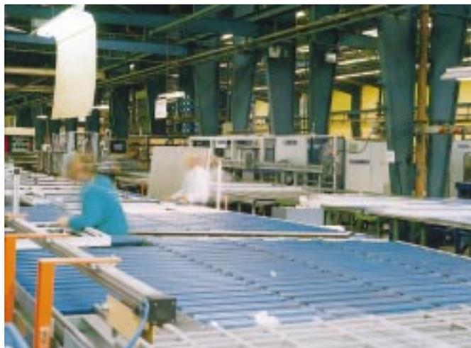
Die Fertigungsstationen sind für einen unterbrechungslosen Durchlauf verketteter: An keiner Stelle entstehen Fehlzeiten
