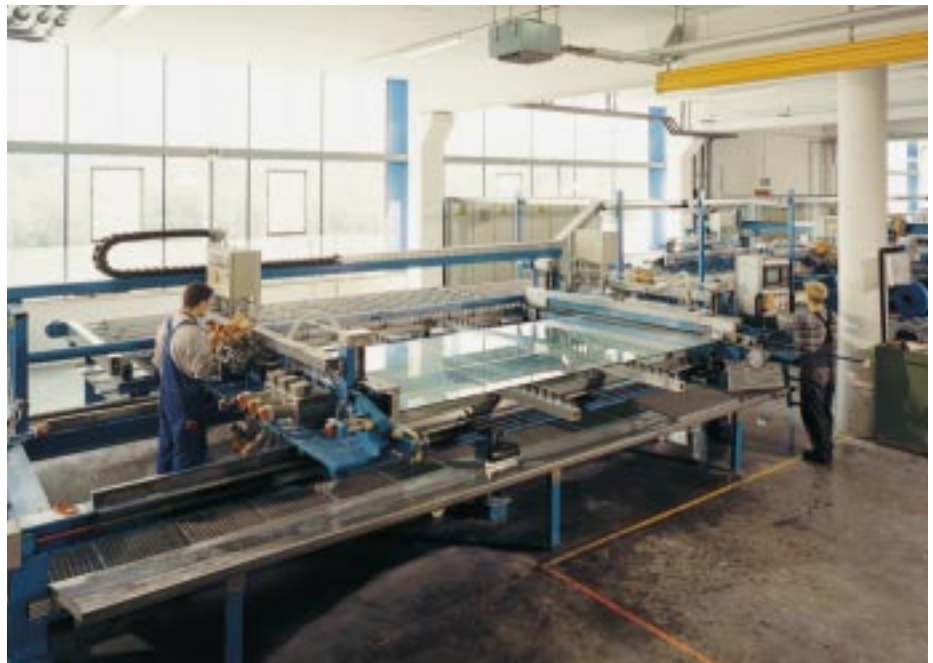
Von Benteler bei BGT: das neue Bearbeitungszentrum für Schleifen, Bohren und Waschen Bild: BGT
