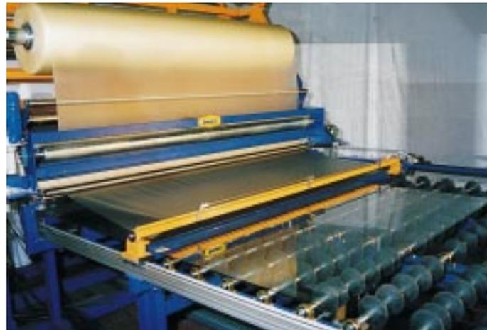
*Automatischer Folienschnitt an der Montagezelle
