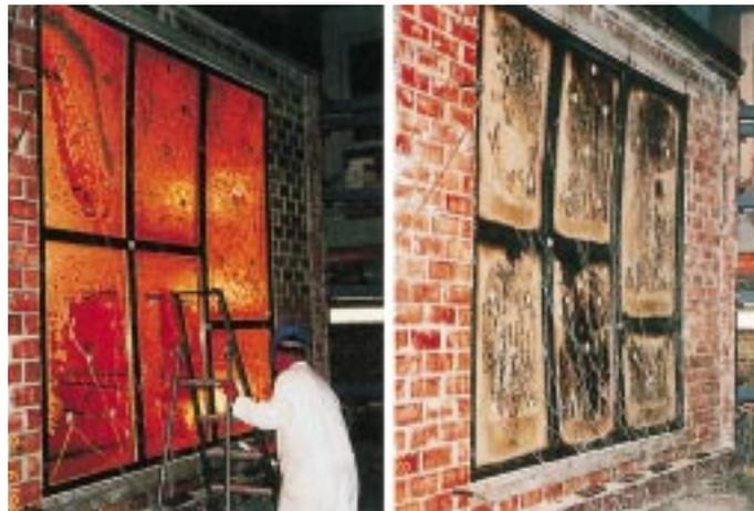
„Pyranova“ mit aufschäumendem Bayfox-Gel im Brandversuch nach ca. 5 bzw. 100 Minuten
