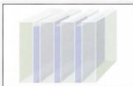
PYRANOVA F 30-S1 Basisglas besteht aus 3 mm Kalk-Natron-Floatglasscheiben und eingelagerten Bayformox-Gelschichten.
