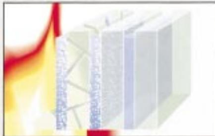
Läßt die Hitzeabschirmung nach gewisser Zeit nach, zerspringt die zweite Scheibe. Die dahinter liegende Gelschicht bildet eine neue Hitzesperre.
