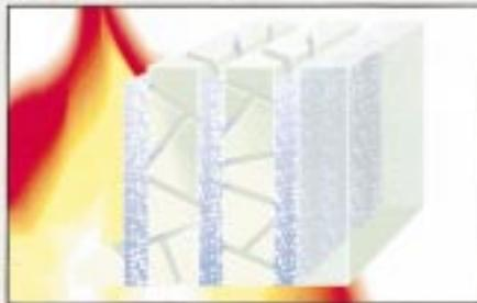
Nach über 30 Minuten besteht mit der dritten Gelschicht noch volle Hitzeabschirmung.
