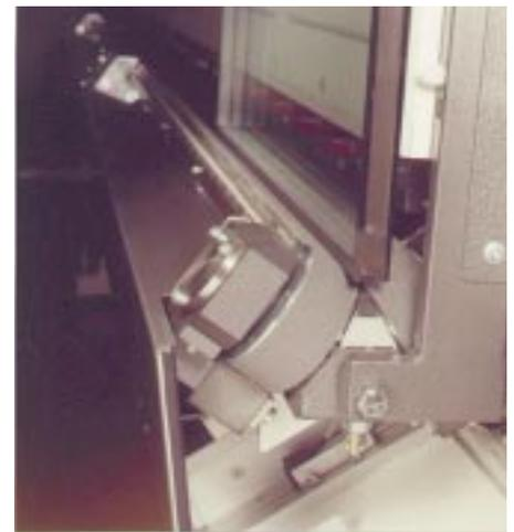
*V-förmiges Fördersystem für schonenden Glastransport ohne Glasbruch und Verschmutzung der Glasunterkanten*
