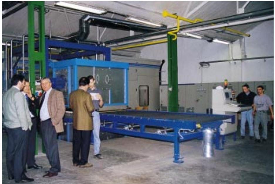
Diese gasbefeuerte Glafurit-Vorspannanlage bei Kinon/Aachen ist auf die ESG- und VSG-Palette sowie die Brandschutzgläser des Unternehmens abgestimmt Bild: Hager
