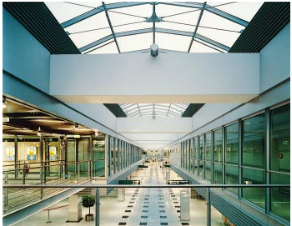
Die Galerieebene im Flugsteig A: Durch ein 170 m langes Glasdach und umfassende F 30-/T 30-Verglasungen entstand ein helles, großzügiges Ambiente
