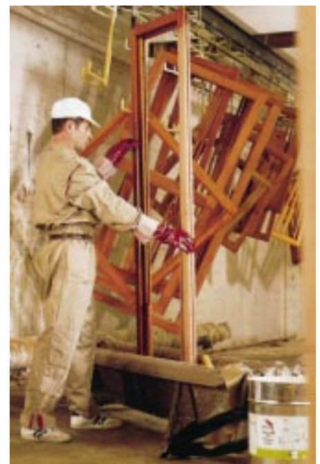
Die Grundierung mit „Glassohyd OPS“ kann sowohl im Flut- als auch im Tauchverfahren auf den üblichen Anlagen erfolgen
