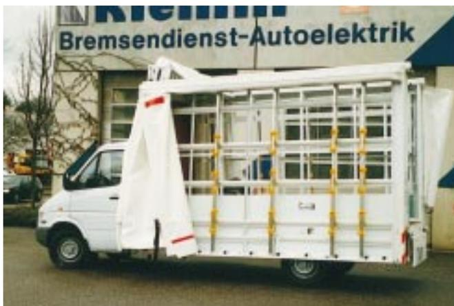
Mercedes „Sprinter“ mit beidseitig über die Pritsche heruntergezogenem (Doppel-)Reff, Sonderpritsche, Planeschiebvorhänge auf beiden Seiten und verschiebbarem Dach
