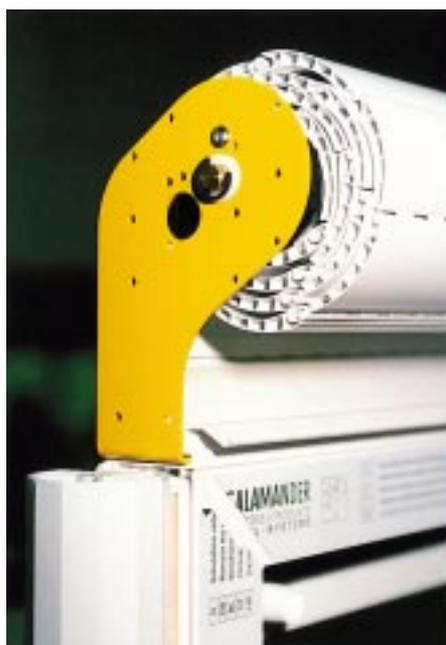
Das System „Fenro“ ist simpel: Zwei flexible Lagerbockwinkel, 3 mm Stahlblech, pulverbeschichtet, halten eine 60 mm/Achtkant-Teleskopachse 0,6 mm; links und rechts der Achse sind zwei ABS-Hülsen aufgesetzt; zwei in den ABS-Hülsen fixierte Achsstifte aus verzinktem ST 37 K bewegen sich stufenlos in einem unverwüstlichen POM-Lager
