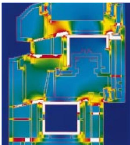
Bild 2: Um die Entkopplung des Stahles weiter zu verstärken, wurde bei der nächsten Variante die Bautiefe von 70 mm auf 72 mm erhöht. In Richtung des Wärmeflusses war nun Platz für eine weitere Kammer. Zusätzlich wurde der Stahl auf zwei PVC-Füße gestellt, der den direkten Kontakt zum Blendrahmenrücken verhindern sollte
