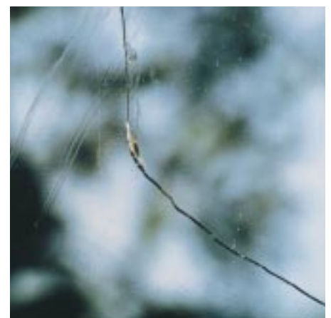
Bild 25: Wallner'sche Linien, im Mittel-bereich eines thermischen Sprungs, aus der Richtung und Laufgeschwindigkeit diagnostiziert werden können
