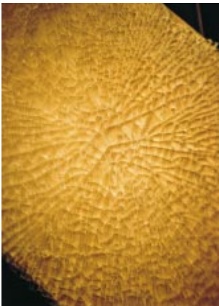
Bild 19: Nickelsulfid, gesichertes Bruch-teil aus Bild 18
