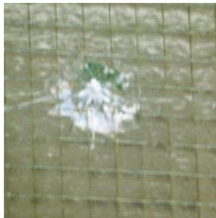
Bild 21: Drahtglas mit Steinschleuder-bruch durch herabfallenden Stein verur-sacht, der vermutlich von einem Vogel gefallen lassen wurde; Nr. Period.-System: 1 C, Gruppen-Nr. 010
