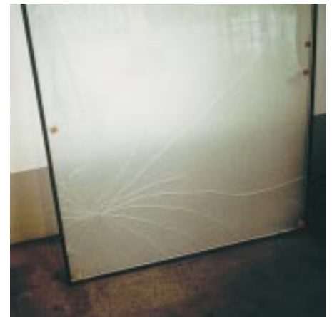
Bild 23: Punktlast durch Steinchen zwi-schen zwei gepackten Isolierglasscheiben; Nr. Period.-System: 1 C, Gruppen-Nr. 016
