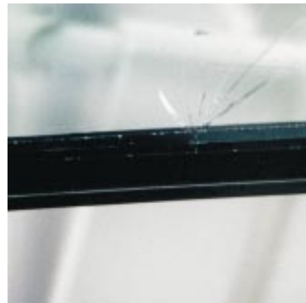
Bild 16: Palmsprung, bei beschichtetem Wärmeschutzglas durch längere innere Teilabdeckung mit dunklem Kissen verursacht; Nr. Period.-System: 2 A, Gruppen-Nr. 002
