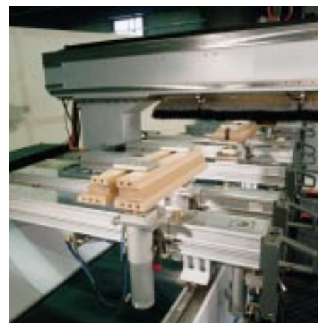
Einzelteilbearbeitung von Fensterkanteln auf einem Bearbeitungszentrum
