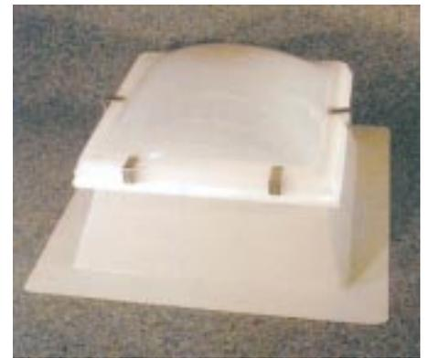
gel aus rostfreiem Stahl benötigt keine Schrauben, sondern wird mit Handdruck zusammengepreßt. Durch den hörbaren „Click“ wird bestätigt, daß die Lichtkuppeln gegen Wind und unbefugtes Demontieren gesichert sind. Die Kuppeln sind dadurch schnell und einfach montiert und die nötige Ausdehnungsmöglichkeit ist gewährleistet. Das Risiko von Ribbildung bei der Verschraubung und das Eindringen von Wasser ist so nach Angaben des Herstellers ausgeschlossen.
