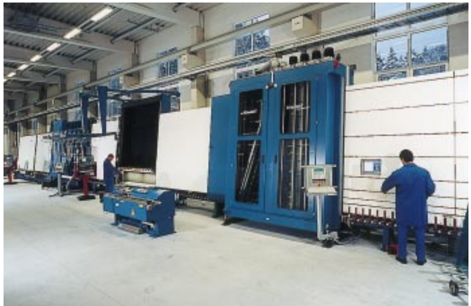
Mit kompletter Leistungsbreite: v.r.n.l. Glasplatten Waschmaschine, Visitier- und Rahmenauflegestation, Zusammenbau-, Gasfüll- und Preßautomat, 1-Kopf-CNC-Versiegelungsautomat
