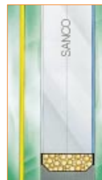
Wirkungsvolle Schalldämmung: Kombination aus Floatglasscheibe und GH-Verbund-scheibe
