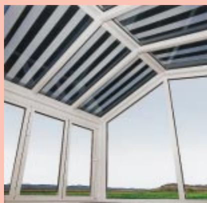
Das erste Wintergartendachsystem mit integrierter Beschattung: In den Gashalteleisten der Träger des Wintergartens werden Führungsschienen integriert, die es ermöglichen, den Sonnenschutz des Wintergartendaches auszufahren
