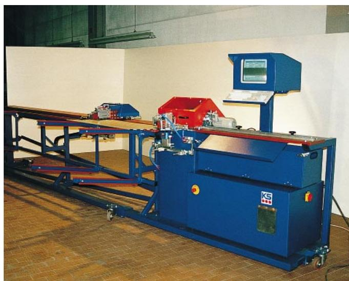
*Die computergesteuerte Rolladenpanzer-Arretiermaschine „KS AluKap 350“ zieht die Rolladenstäbe selbständig ein, längt sie exakt ab und arretiert den Rolladenpanzer durch Kappen, die beidseitig eingeschlossen und mit Klammern fixiert werden*
