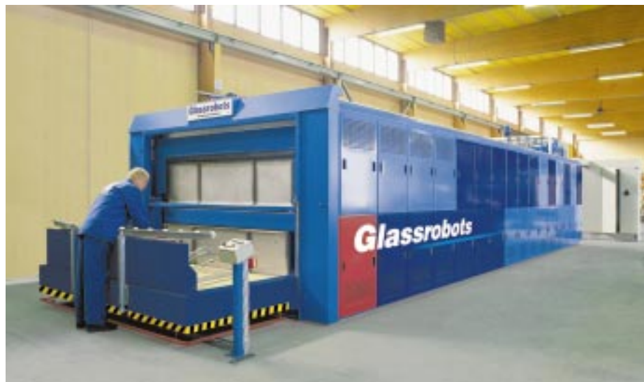
Bild 6 Serieller Biegeofen für Windschutzscheiben für Ersatzteile oder Erstausrüstung mit innovativem Steuersystem „FuzzyBend“, Ferndiagnose, Zustandsüberwachung und vertikal verstellbaren Heizelementen
