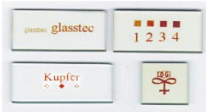
Abb. 1: Durch  $\text{CO}_2$ -Laserbestrahlung erzeugte Farbstrukturen in ionenausgetauschtem Floatglas. Originalbreite der Glasstreifen: 20 mm
