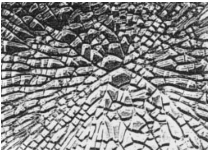
Bild 8: Typisches Fehlerbild nach einem NiS-induzierten Spontanbruch
