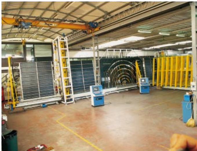
Vertikale, komplett automatische Schneidelinie für Verbundglas Bild: For.el
