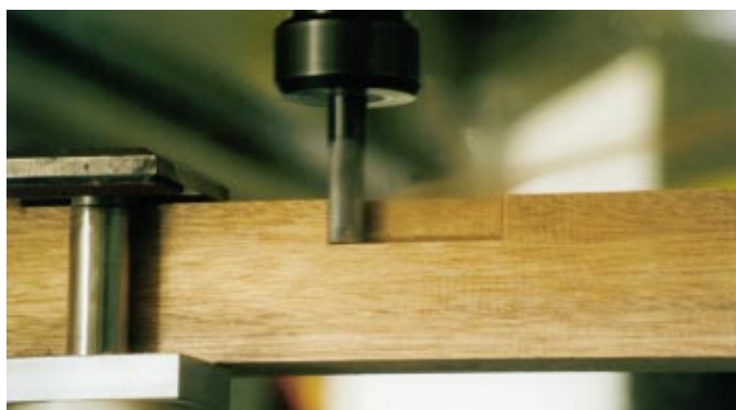
Paßgenau: Fräsen des Paßsitzes für die bündig eingelassenen Schließteile
