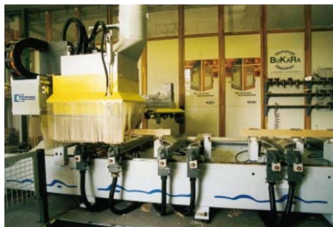
Wirtschaftlich: Die Fertigung auf dem CNC-gesteuerten Bearbeitungszentrum „Homag BOF 311/40/PF Genius“
