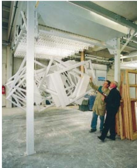
*Neue Flutanlage bringt Leistung: Einfallreicher Unternehmer entwickelt automatische Fenstertransport-Anlage*
