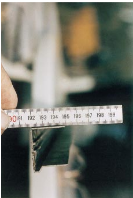
Bild 9: Die vorstehende Profilgebung beträgt höchstens 2 mm Bilder: Schultes
