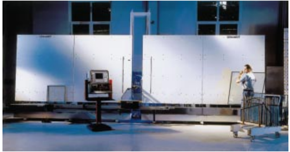
Der neue Lenhardt 2-Kopf-CNC-Versiegelungsautomat
