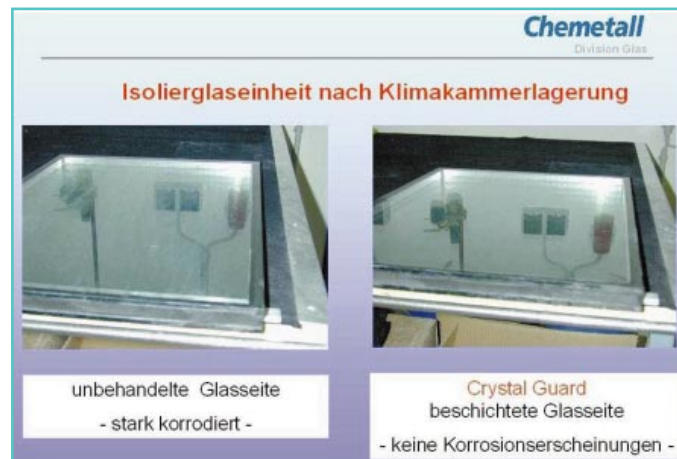
Abbildung Korrosionsschutz: Einseitig mit „Crystal Guard“ beschichtete Isolierglaseinheit nach Lagerung in der Klimakammer Bild: Chemetal
