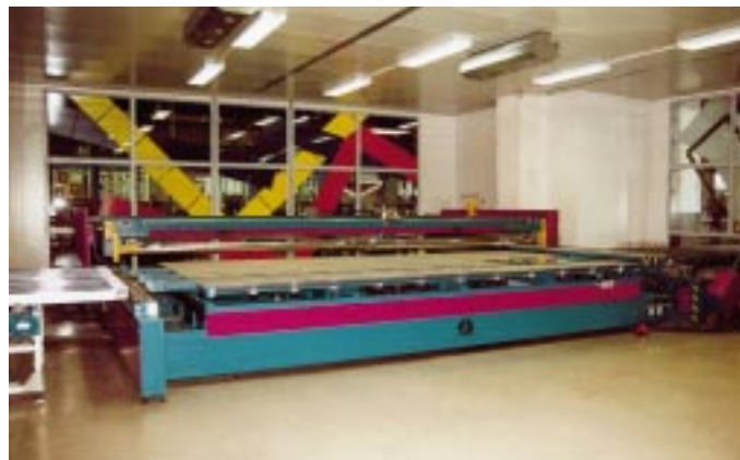
Siebdruckmaschine „Typ SH“ (Druckformat 2600 × 5500 mm) zum Bedrucken von Flachglas
