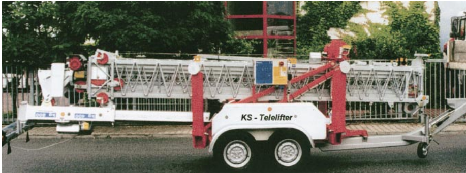
Der „KS-Telelifter“ für große Glaselemente im Fassaden- und Dachbereich
