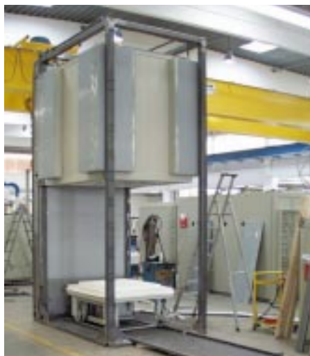
Bild 5: Temperofen für Quarzglas bis 1550 °C „Nabertherm Variotherm HC 665/S“
