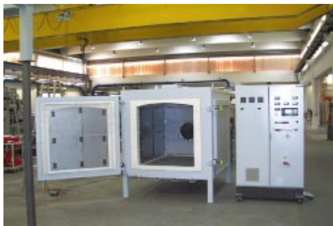
Bild 10: Glasbiegeofen für optische Gläser Bild: Gero
