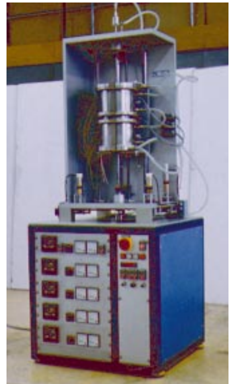
Bild 10: Glasbiegeofen für optische Gläser Bild: Gero
