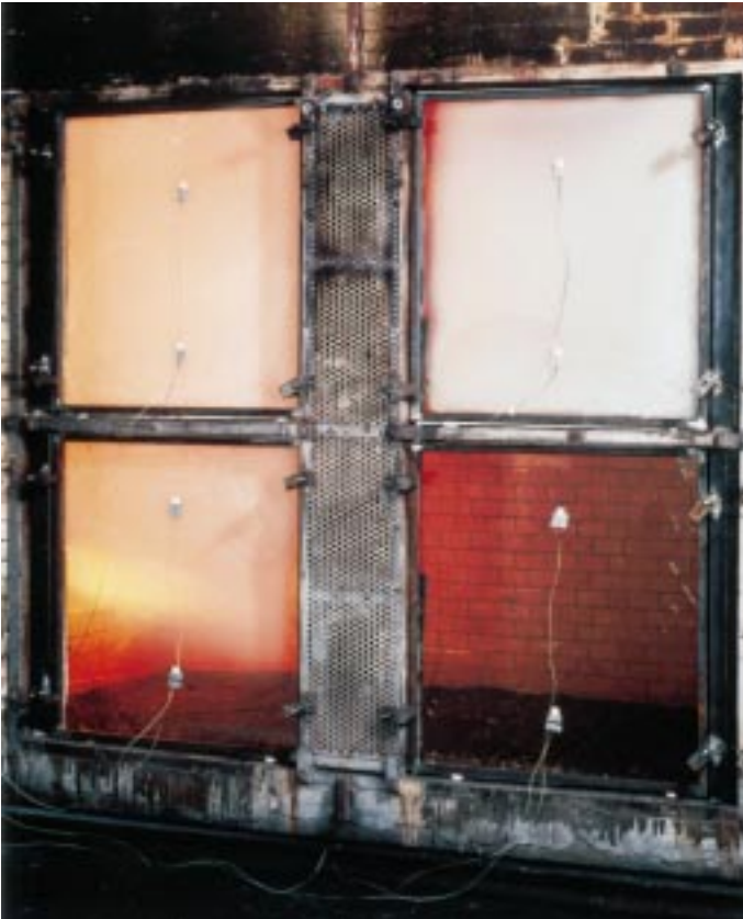
Bild 1: Frühphase des Brandversuchs: Unter fortlaufender Brandeinwirkung verliert Pilkington „Pyrostop“ seine Transparenz; die Wasserglasschichten schäumen zu einer zähen Masse auf
