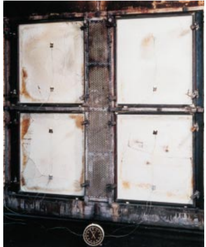
Bild 2: Endphase des Brandversuchs: Die Glasflächen sind vollständig aufgeschäumt; die Anforderungen an Feuer- und Rauchdichte sind bei diesem fast 20 Jahre alten „Pyrostop“-Glasytp für die Feuerwiderstandsklasse F 30 sogar noch nach über 50 Minuten gegeben
