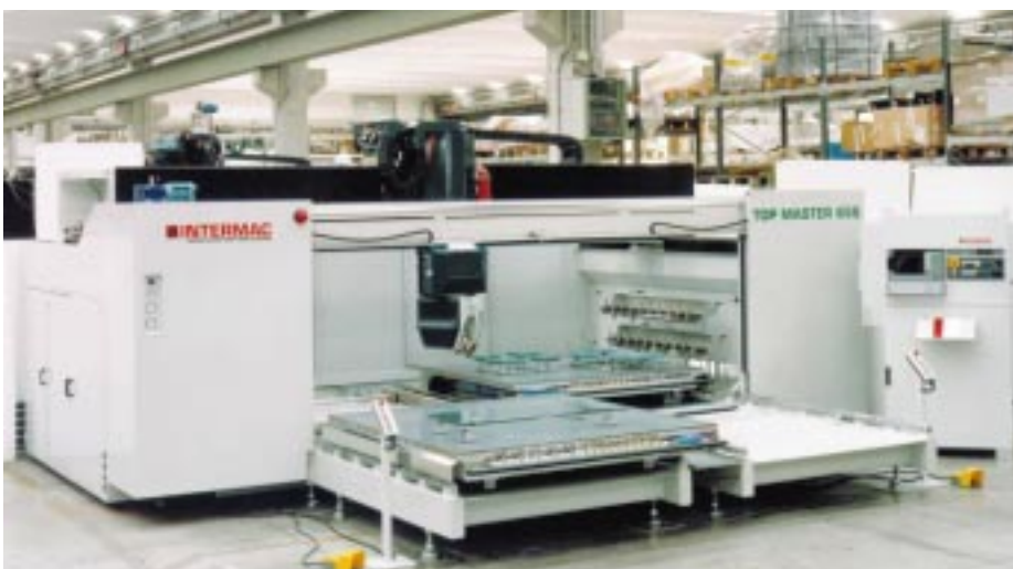
Variante „Top Master 655 TB“ mit geteilt ausfahrbarer Arbeitsfläche
