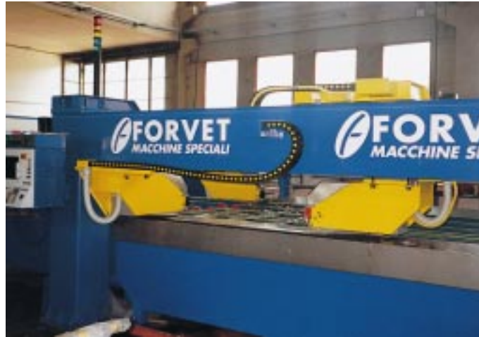
Vierseiten-Schleif-automat mit sieben CN-gesteuerten Achsen „Chiara 2000“ für wechselnde Glasmaße Bild: Forvet
