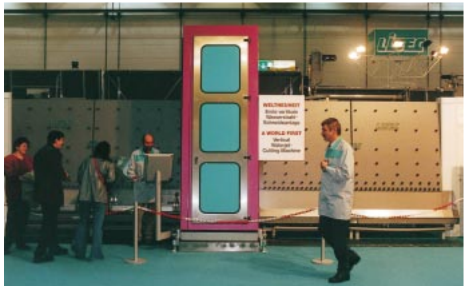
Weltneuheit: erste vertikale Wasserstrahl-Schneidanlage, gesehen bei Lisec
