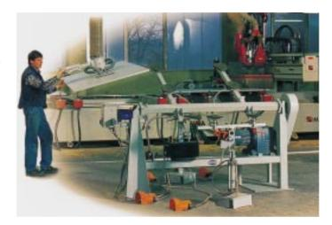
Sperrige Platten mühelos schwenken mit dem "Vakuum-Wendetisch PVT 180°" Bild: J. Schmalz
