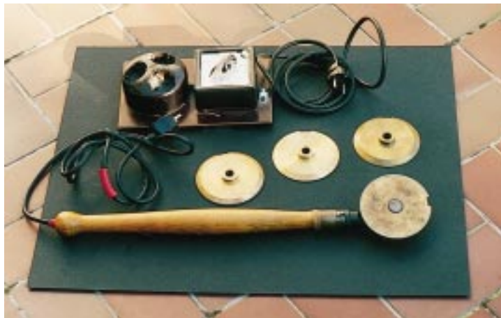
Werkzeugset mit Vergolderolle für die Ausführung von Linierungen mit Echtgoldfolien
