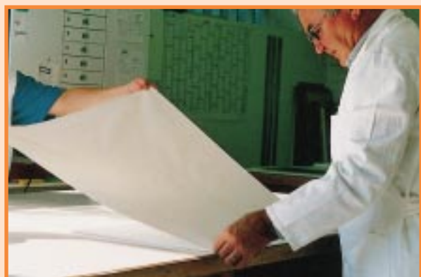
Bild 9 Der Büttenbogen wird über dem Maskenoberfläche paßgerecht ausgerichtet
