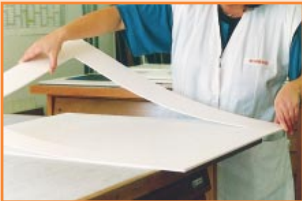
Bild 5 Die Passepartout-Maske wird auf die Rückwand geklebt
