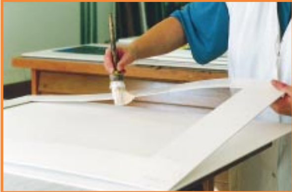
Bild 4 Anschmieren der Passepartout-Maske (Rückseite oben)
