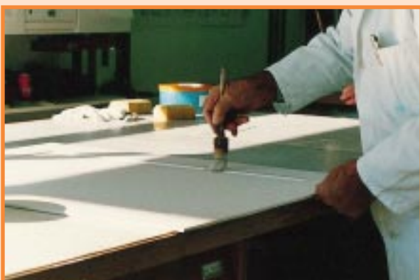
Bild 6 Die Schnittfasen werden zusätzlich mit Buchbinderleim angeschmiert
