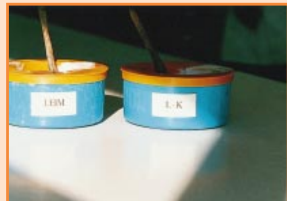
Bild 3 Buchbinderleim (links) und Leim-Kleister-Mischung als Kaschierklebstoffe
