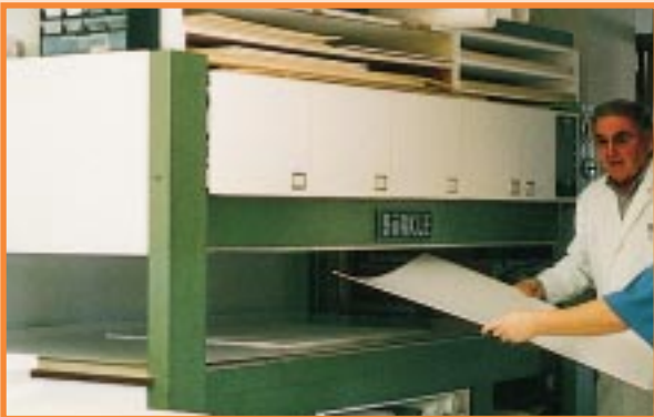
Bild 12 Einlegen des Werkstücks in die Furnierpresse für die Probepressung
