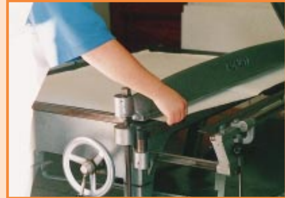
Bild 1 Büttenpapier zuschneiden, unter dem Schneidhebel der Pappschere
