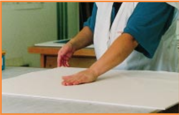
Bild 10 Glattstreichen des Büttenbogens, Entfernen von Falten, Knittern und Luftblasen
