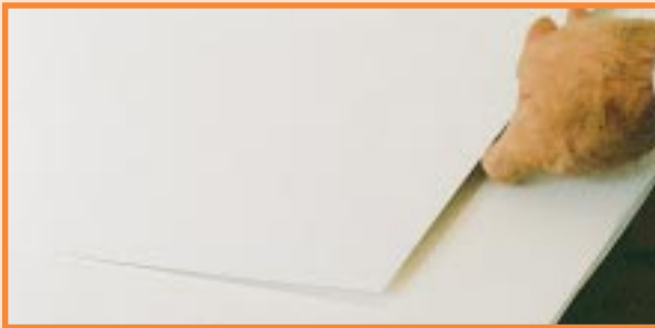
Bild 11 Das Ausfallstück wird für den Preßvorgang in den Fensterauschnitt gelegt
