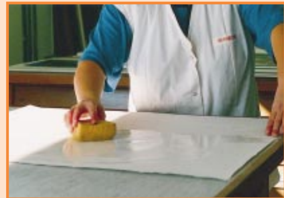
Bild 2 Büttenpapier mit dem Schwamm bis zur Sättigung wässern
