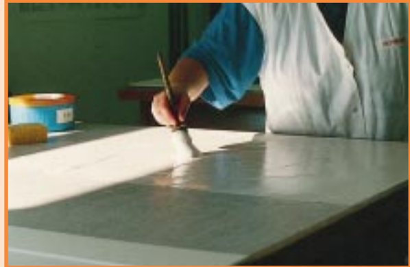
Bild 7 Ein Bogen Büttenpapier (Schauseite nach unten) wird angeschmiert
