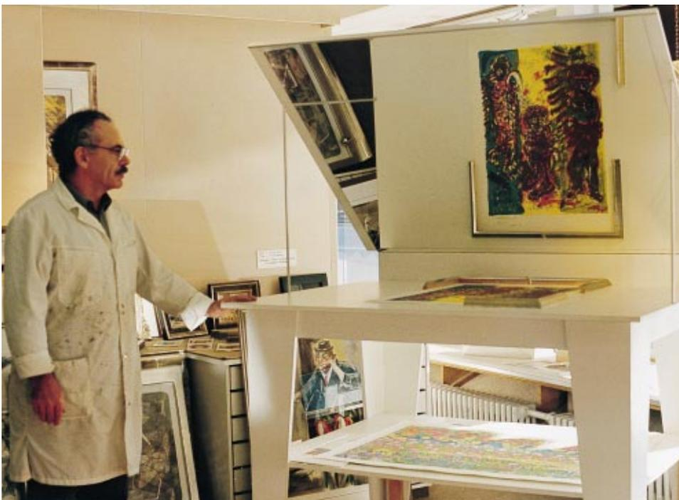
An diesem Spezialtisch (entdeckt bei einem Einrahmer in der Schweiz) lässt sich bequem testen, welcher Rahmen zum Bild paßt. Bild und Musterecken liegen waagrecht auf der Tischplatte und erscheinen gleichzeitig senkrecht auf der schräg gestellten Spiegelfläche. Im Einsatz bei der Kundenberatung hat sich dieser Tisch gut bewährt. Für den Glaser ist es ein leichtes, sich einen dieser Art selbst zu bauen
