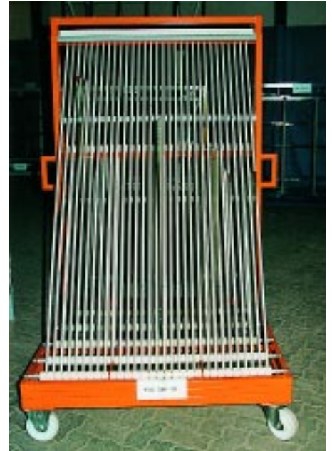
Scheibensortierwagen mit 30 Einstellplätzen – für eine hohe Leichtgängigkeit sorgen die Rollen, auf denen die Scheiben laufen Bilder: Düppel
