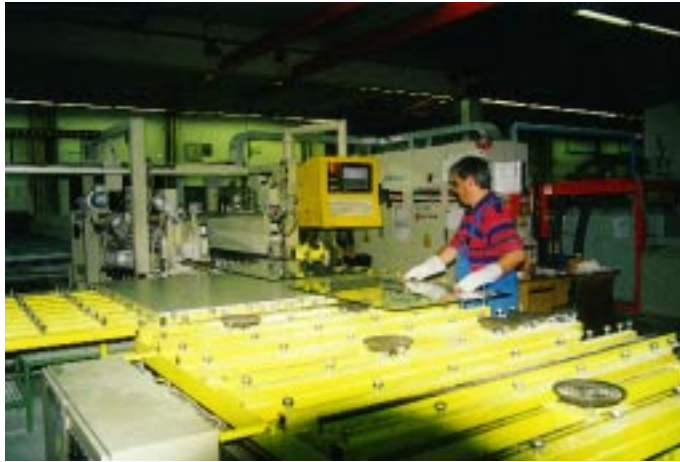
Maschineneinlauf in die integrierte Schleif- und Bohrstraße
