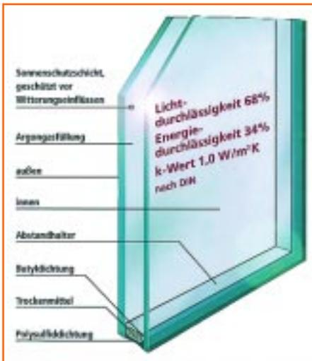
Das Sonnenschutzglas „Ipsol neutral 68/34“ mit hohem Lichtdurchlaß und niedrigem  $k_V$ -Wert eignet sich besonders für energetisch optimierte Gebäude
