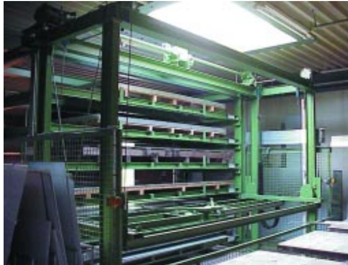
Das Blechlager-system erlaubt eine platzsparende Lagerung und einen schnellen, gezielten Materialzugriff Bild: Scheffer
