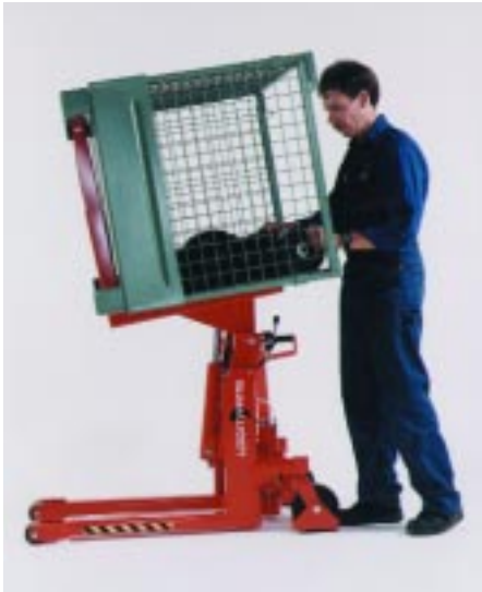
Der „Logitilt“ erlaubt es, in einer ergonomisch richtigen Weise eine Gitterbox zu heben oder zu transportieren, was eine geringere körperliche Belastung bedeutet Bild: Logitrans
