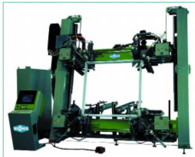
Die vertikale Vierpunktschweißmaschine „SMV-4“ kann in eine komplette Linie integriert werden Bild: Haffner
